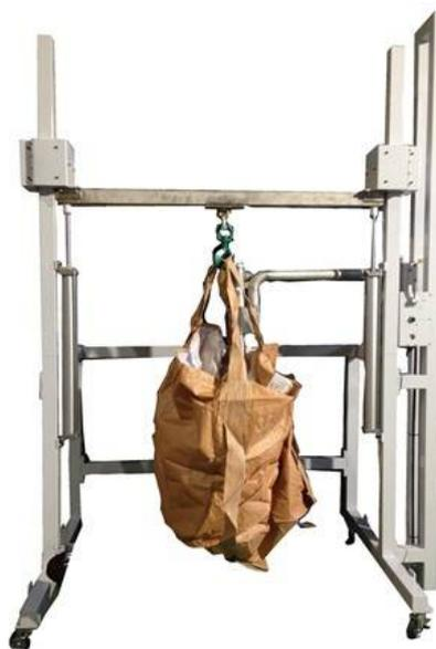
④フレコンがセットし終わったら昇降バーを上昇させます。
