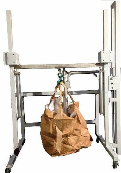
③サクショパイプを自由落下にしてフレコンバッグに刺さる様に誘導します。
