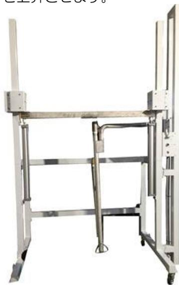
⑥サクショパイプを上昇させ、昇降バーを下げフレコンバッグを外し、新しいフレコンバッグをセットします。そのあとは②にもどります
